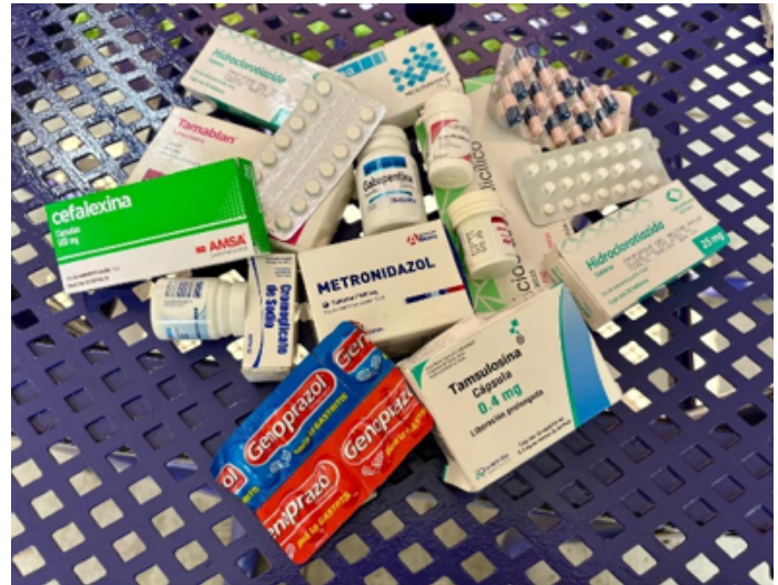
Figura 2. Medicamentos caducos utilizados como inhibidores de la corrosión. Crédito fotográfico: Omar Alejandro González Noriega.
